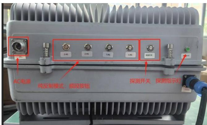
拧上对应的天线（反制/探测天线），接上220V市电。
